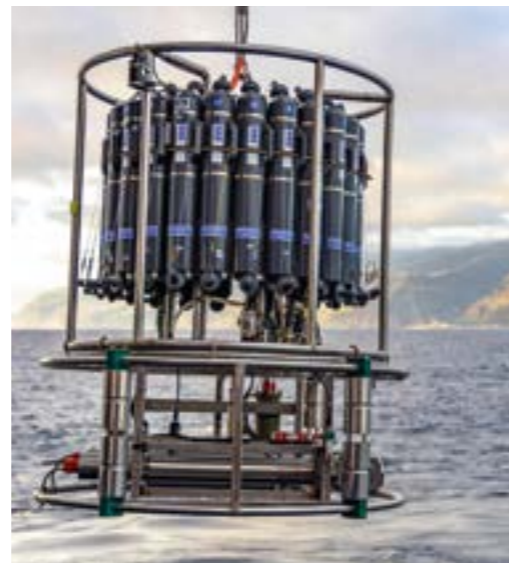
Die CTD-Sonde wird ins Wasser gelassen. Ein CTD ist ein ozeanografisches Messgerät zur Bestimmung der elektrischen Leitfähigkeit (conductivity) und der Temperatur (temperature) in Abhängigkeit von der Wassertiefe (depth). Aus der Leitfähigkeit wird unter Berücksichtigung von Temperatur und Druck der Salzgehalt ausgerechnet. Kombiniert mit 24 Niskin-Flaschen können Wasserproben und die darin befindlichen Organismen aus verschiedenen Tiefen genommen werden. Mit den Daten und Proben lässt sich dann das Profil einer Wassersäule erstellen. Zusätzlich werden die Wasserproben auf DNA untersucht. Meerestiere verlieren beim Schwimmen, Atmen, Fressen und Kotabsatz ständig Zellen und DNA, was zur Freisetzung von genetischem Material führt. Diese Umwelt-DNA wird gesammelt, aufbereitet und identifiziert.
