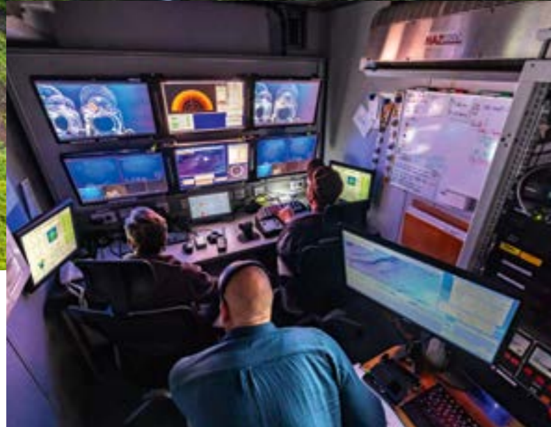
Höchste Konzentration im ROV-Kommandoraum: Zwei Piloten sitzen vor den Monitoren und steuern den Tauchroboter, während Meeresbiologe Dr. Henk-Jan Hoving Tiefseelebewesen in Echtzeit beobachten und Anweisungen geben kann. Mit der Slurp Gun – eine Art Staubsauger – werden dann empfindliche, gallertartige Organismen schonend eingesammelt. Ein komplexes Unterfangen, da die Piloten dazu auf einen zweidimensionalen Bildschirm schauen müssen, um in einem dreidimensionalen Raum viele Hundert Meter unter ihnen kleinste Lebewesen einzusaugen.
