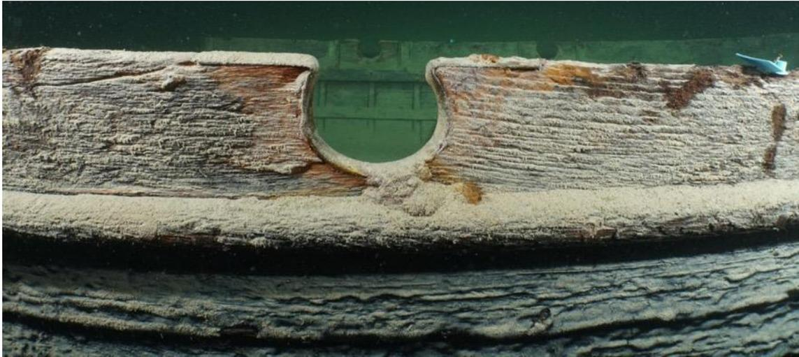
Abbildung 26: Ruder-Dolle mit Stahlbeschlag
