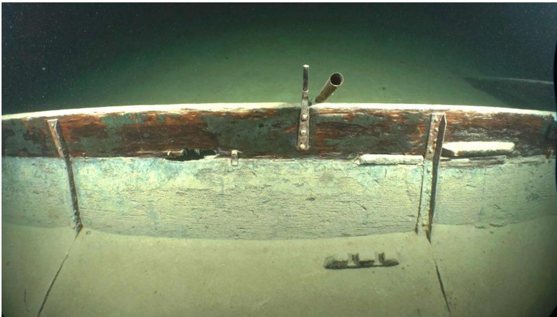
Abbildung 35: Stahlspante und Aufnahme für Ruderrolle oder -gabel
