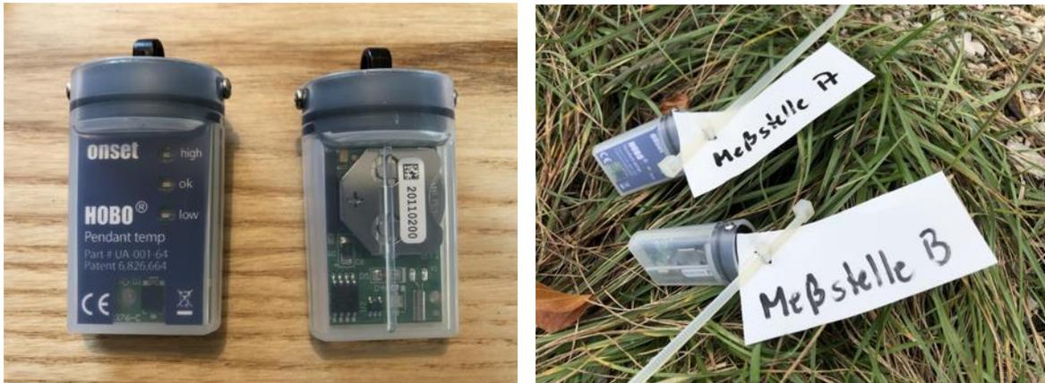
Abbildung 9: Temperaturdatenlogger zur Anbringung am Wrack
