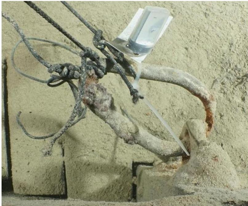
Abbildung 23: Öse im Bootsinneren befestigt am Heckspiegel, Temperatur-Datenlogger
