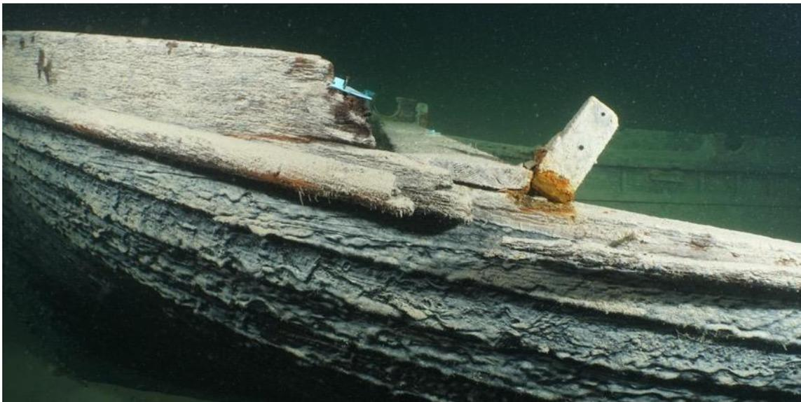
Abbildung 27: Beschädigung Bug Backbord, fehlende Ruder-Dolle
