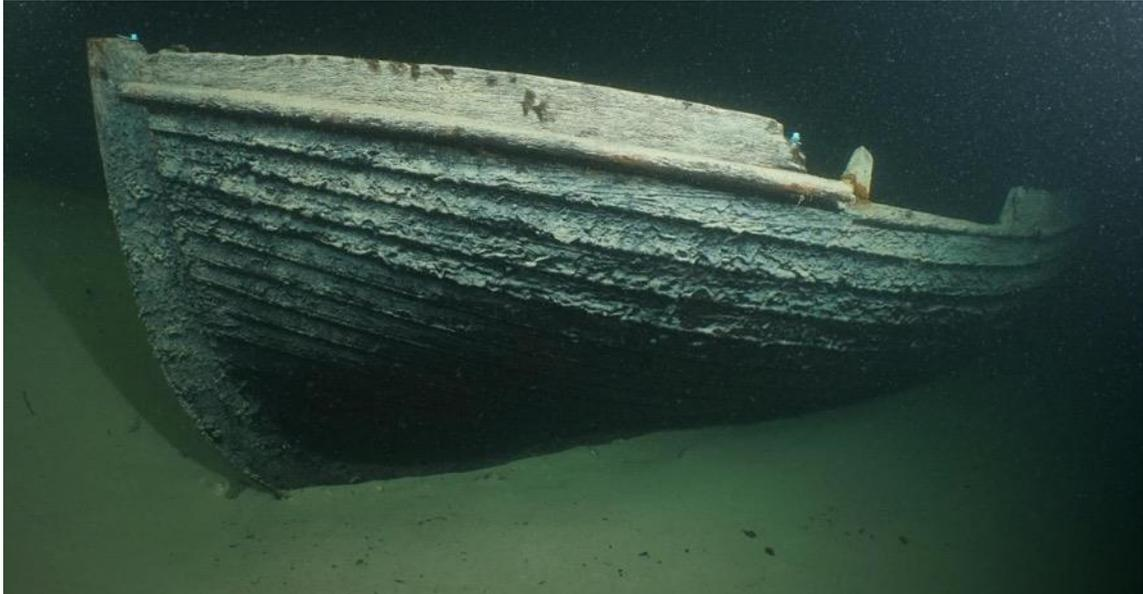
Abbildung 15: Bug backbord – Klinker-Beplankung
