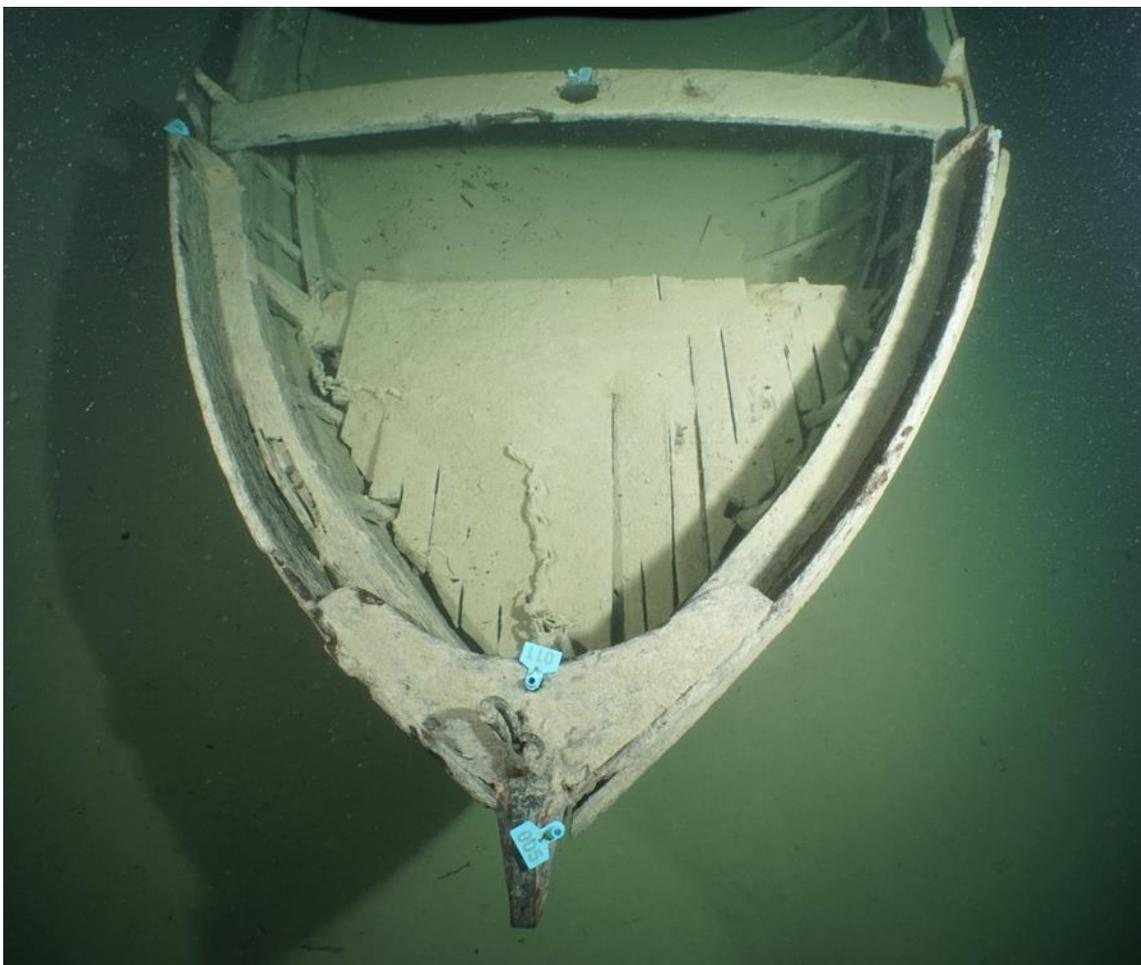
Abbildung 19: Vorschiff mit Ankerkasten
