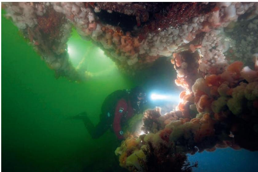
Abb. 6. Taucher am stark bewachsenen Heckbereich, darüber Leitwerkinstallationen inklusive Schutzbügel (Foto: U. Kunz).
