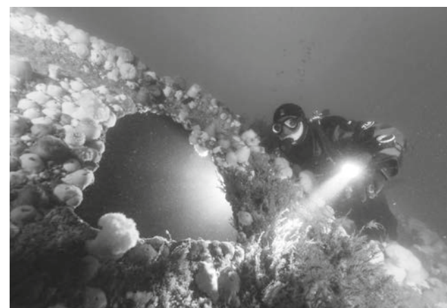
[ 4 ] Unten: Noch ist das Wrack gut erhalten, doch mehr und mehr wird es aufgrund fortschreitender Korrosion zerfallen. Die Außenhülle ist bereits komplett korrodiert, der eigentliche Druckkörper ist noch intakt. Fotografien: Uli Kunz
