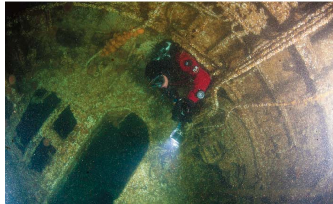
Offenstehende Luken und Schotten sprechen dafür, dass das U-Boot absichtlich von der eigenen Besatzung versenkt wurde.
