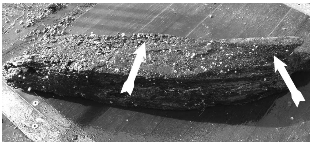
Abb. 5: Aufleger mit deutlichen Brandspuren und Bohrmuschelbefall.
